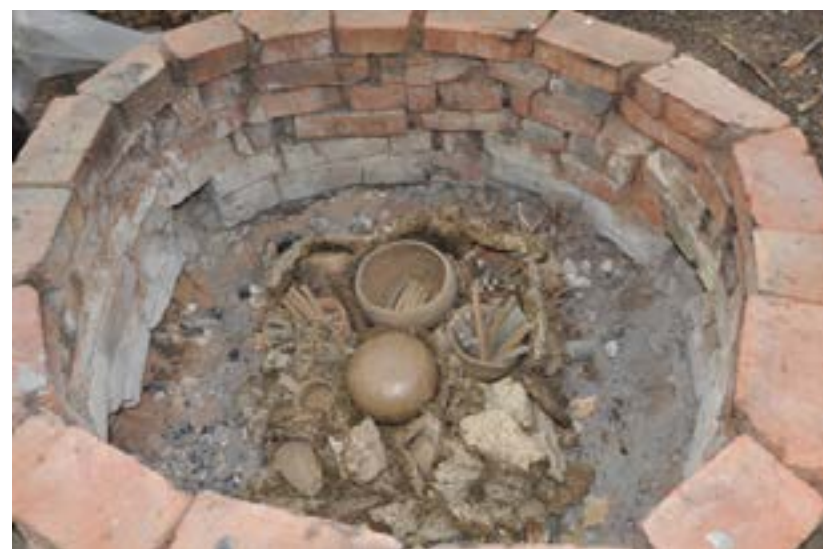
61. Обжиг керамики в смешанном топливе в наземном очаге. Закладка сосудов сухим навозом
