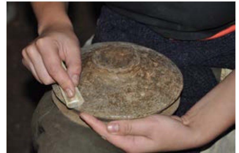
46. Процесс лощения поверхности сосуда костью
