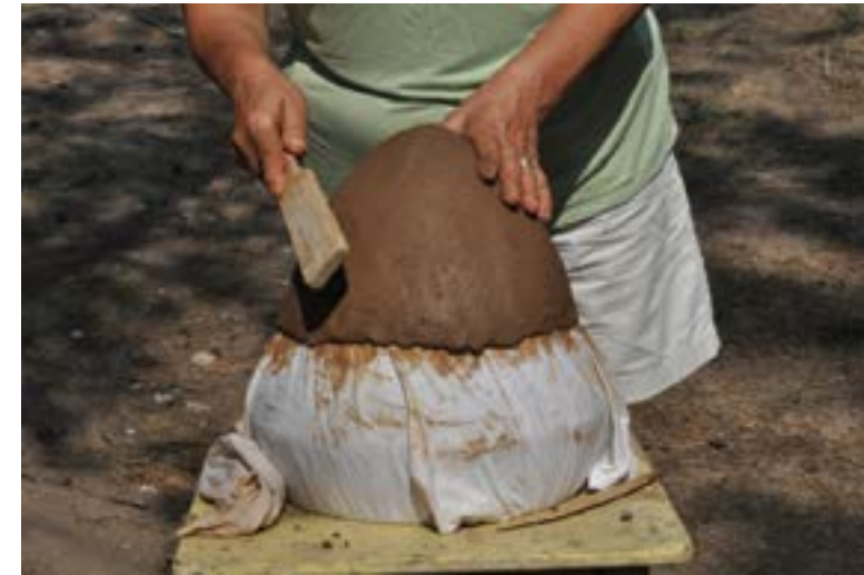
45. Выбивание сосуда гладкой колотушкой на форме-основе
