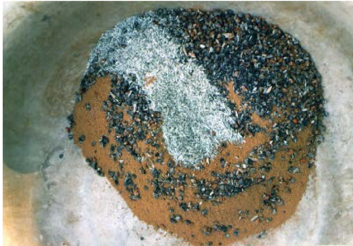
4. Процесс замешивания формовочной массы с шамотом и тальком. Эксперимент
