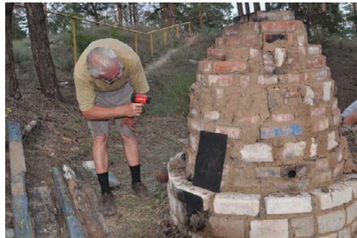
83. Ю.Б. Цетлин измеряет температуру в горне с помощью термомпары. Самарская область, 2013 г.
