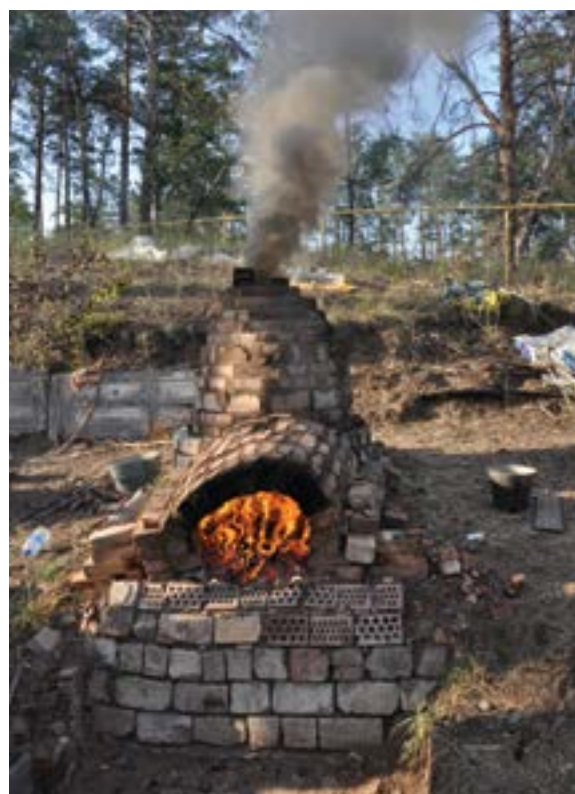
81. Процесс обжига в горне днем
