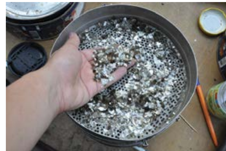
23. Эксперимент со слюдой. Процесс просеивания слюды
