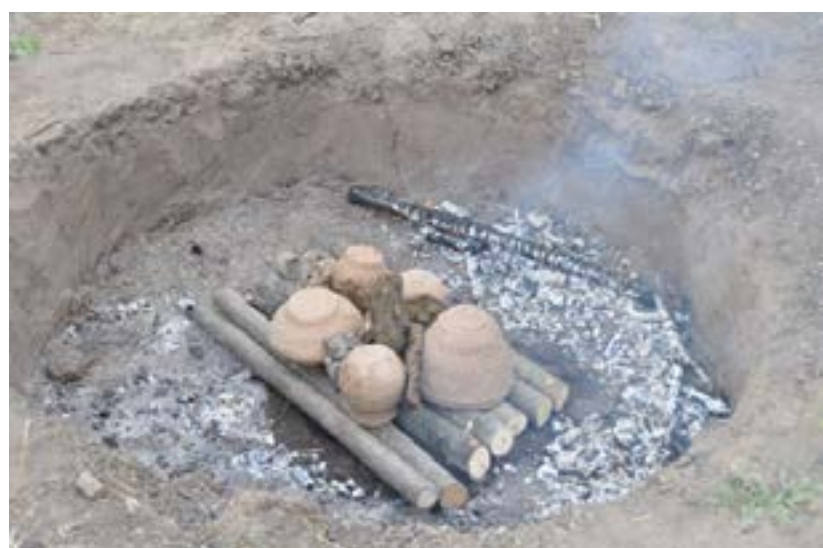
68. Обжиг керамики в смешанном топливе в очаге, углубленном в грунт. Установка сосудов
