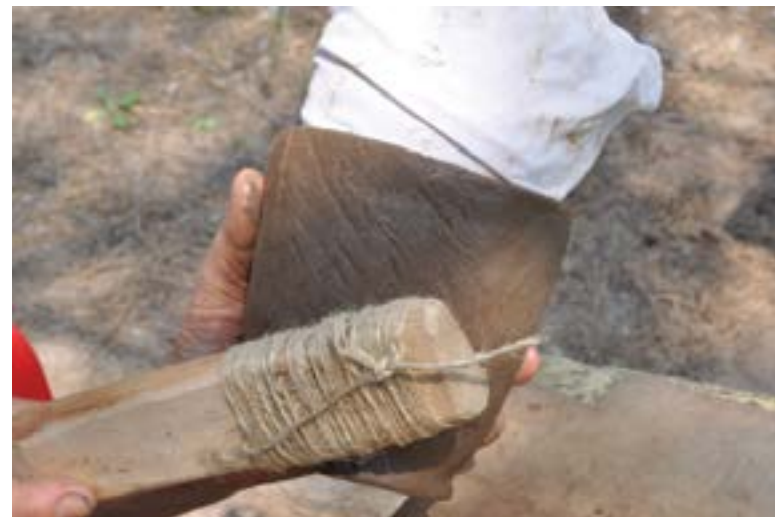
44. Выбивание сосуда колотушкой, обернутой веревкой
